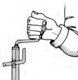
Muista huolehtia tolpan kiristyksestä hyvin. Riittämätön kiristys saattaa aiheuttaa vaaratilanteen.
